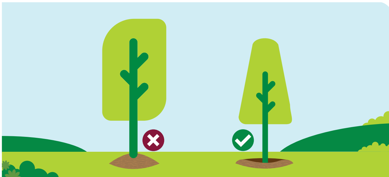
FIGURE 27 : PAILLAGE EN « VOLCAN » INCORRECT MONTRÉ À GAUCHE, ET PAILLAGE EN « BEIGNE » CORRECT MONTRÉ À DROITE DE LA BASE DE L'ARBRE
